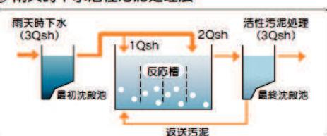
雨天時に1Qshを超えた下水のうちの2Qshについては沈殿処理放流していますが、雨天時下水活性汚泥処理法では沈殿処理放流分の全量又は一部を反応槽後部から流入させて生物処理することにより、公共用水域に放流する負荷量を削減します。
