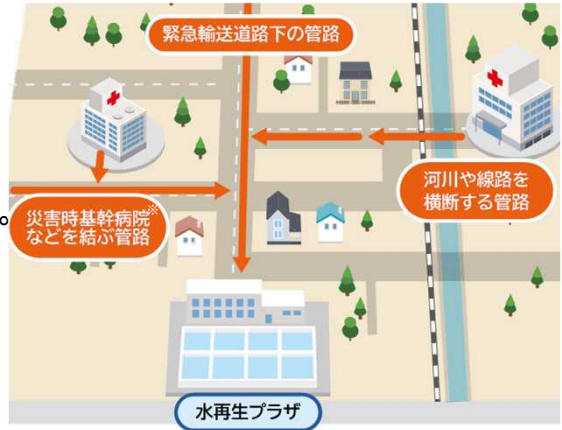
被災時の影響が大きい管路
