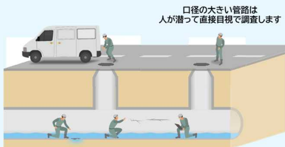
下水道本管の潜行目視調査
