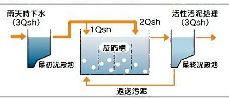
雨天時に 1Qsh を超えた下水のうちの 2Qsh については沈殿処理放流していますが、雨天時 下水活性汚泥処理法では沈殿処理放流分の全量又は一部を反応槽後部から流入させて生物処理することにより、公共用水域に放流する負荷量を削減します。
