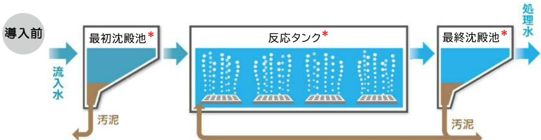
標準活性汚泥法という最も一般的な処理方法であり、反応タンク全体で空気を吹き込むことで、主に下水中の汚れ（有機物）をきれいにする。
