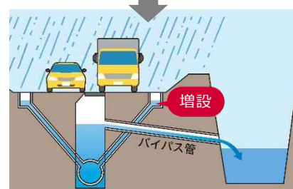
バイパス管の整備
