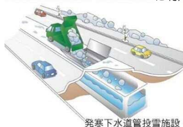
下水道管投雪施設 (2 箇所)
