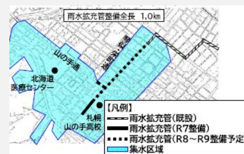
雨水拡充管の整備（山の手地区）
