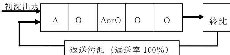
第2処理施設の水処理方法は、反応タンクは全槽好気槽とし、汚泥返送率は晴天日汚水量比約100%の高返送式硝化脱窒運転を行った。
