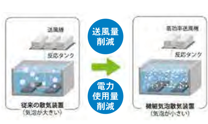
下水道施設における省エネ設備の導入事例
