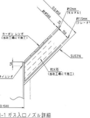
N-1 ガス入口ノズル詳細
