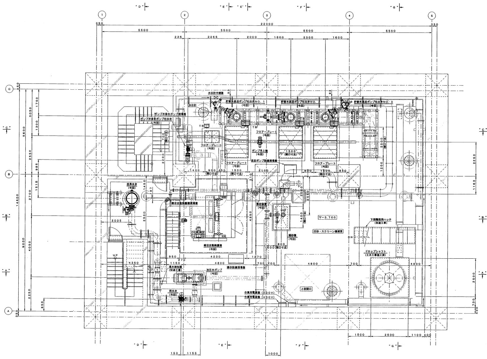
雨水貯留施設 B2階平面詳細図
