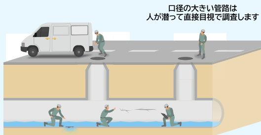
下水道本管の潜行目視調査
