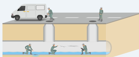
下水道本管の潜行目視調査
