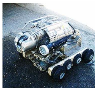
テレビカメラを用いた管路の詳細調査
