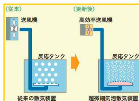
高効率送風機・超微細気泡散気装置導入イメージ
