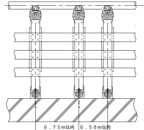
呼び径100mm以下の場合 呼び径150mm～300mmの場合
