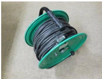
・ヒアリングループ(磁気ループ)システムのアンテナ線
