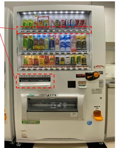
車いす使用者が押しやすい高さに最上段の飲料のボタン
