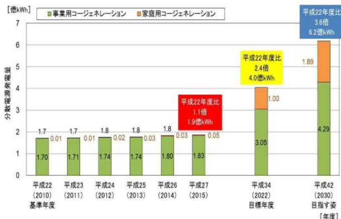
図5 分散電源発電量の達成状況
