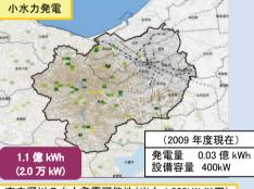
市内河川の水力発電可能地(出力 1.000kW 以下) のすべての範囲に発電機を設置した場合の年間 発電量は 1.1 億 kWh/年
