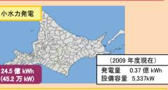
道内河川の水力発電可能地(出力 1,000kW 以下)のすべての範 囲に発電機を設置した場合の年間発電量は 24.5 億 kWh/年
