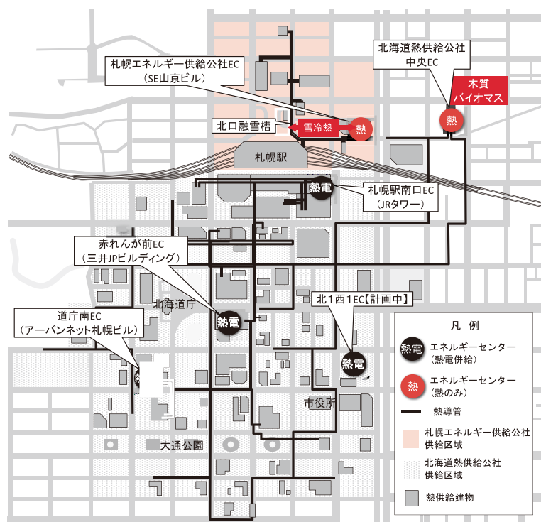
図 2-16 札幌駅北口及び都心地区の熱供給事業の概要
