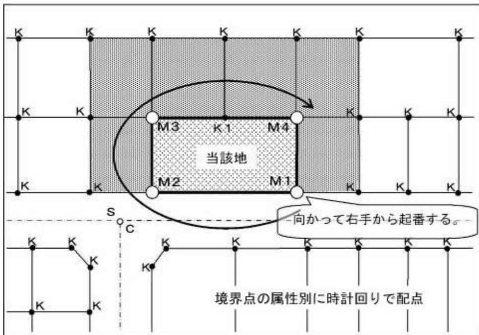
図-5 敷地図・求積図 標準レイアウト
