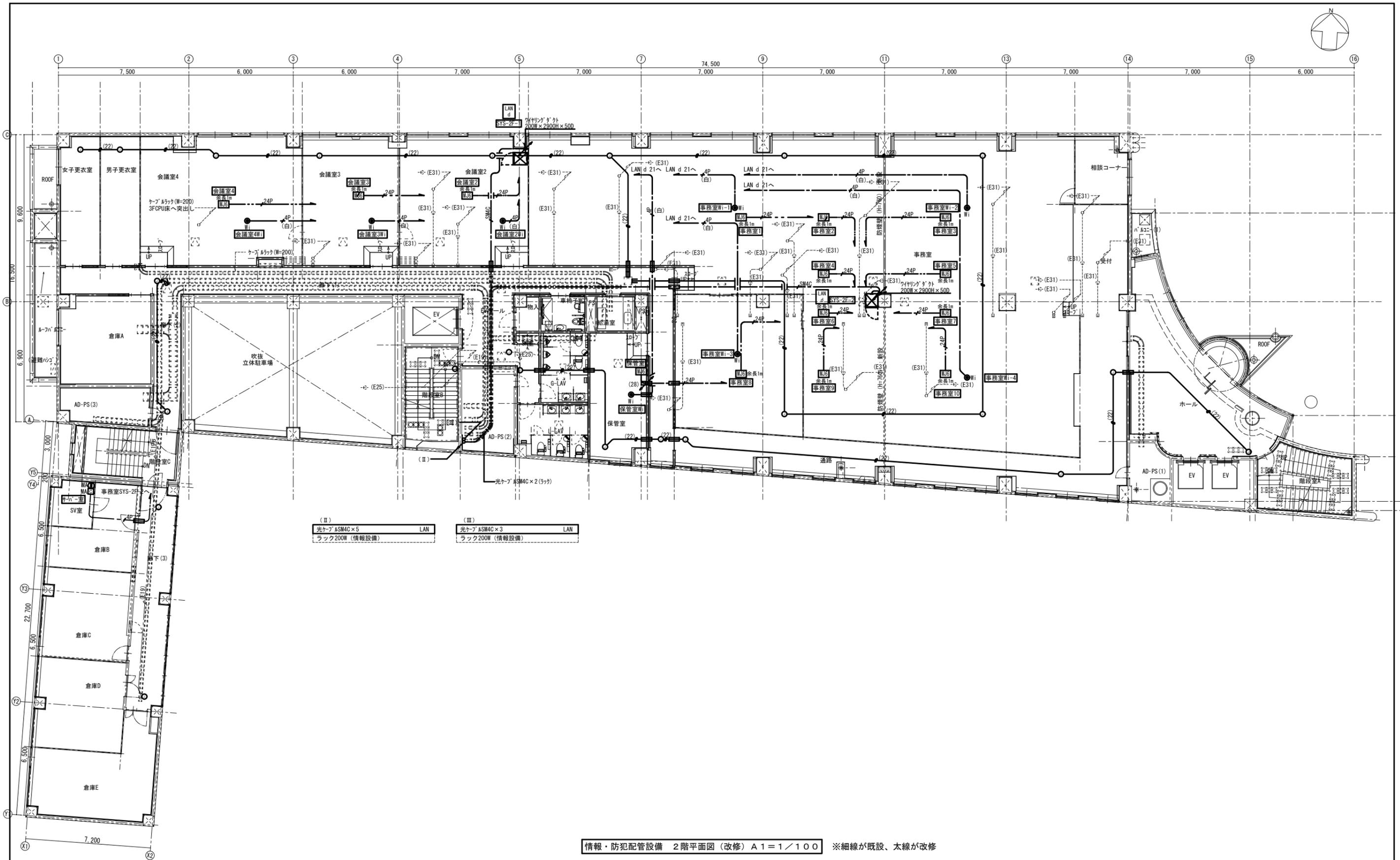
情報・防犯配管設備 2階平面図 (改修) A1=1/100 ※細線が既設、太線が改修
