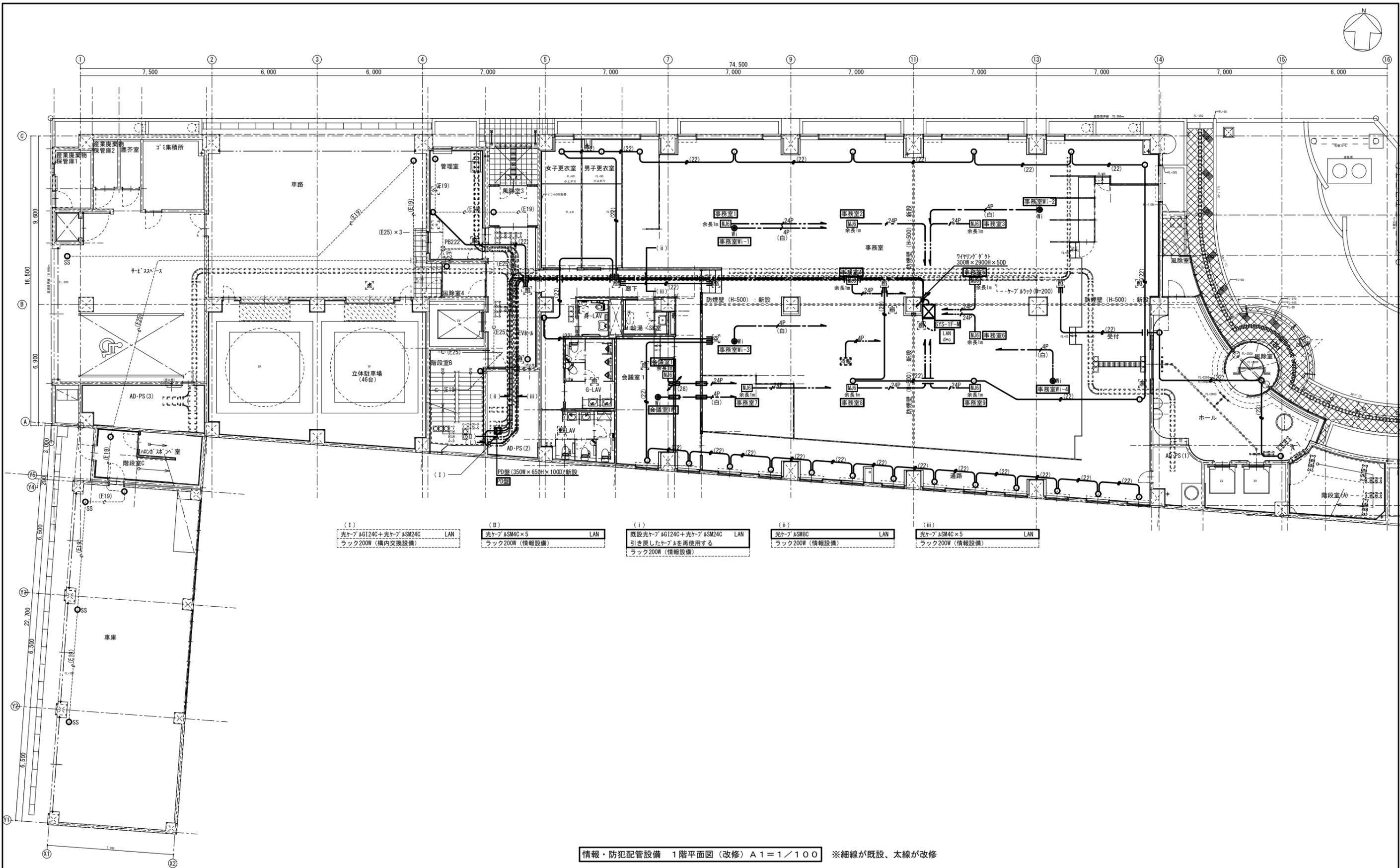
情報・防犯配管設備 1階平面図(改修) A1=1/100 ※細線が既設、太線が改修
