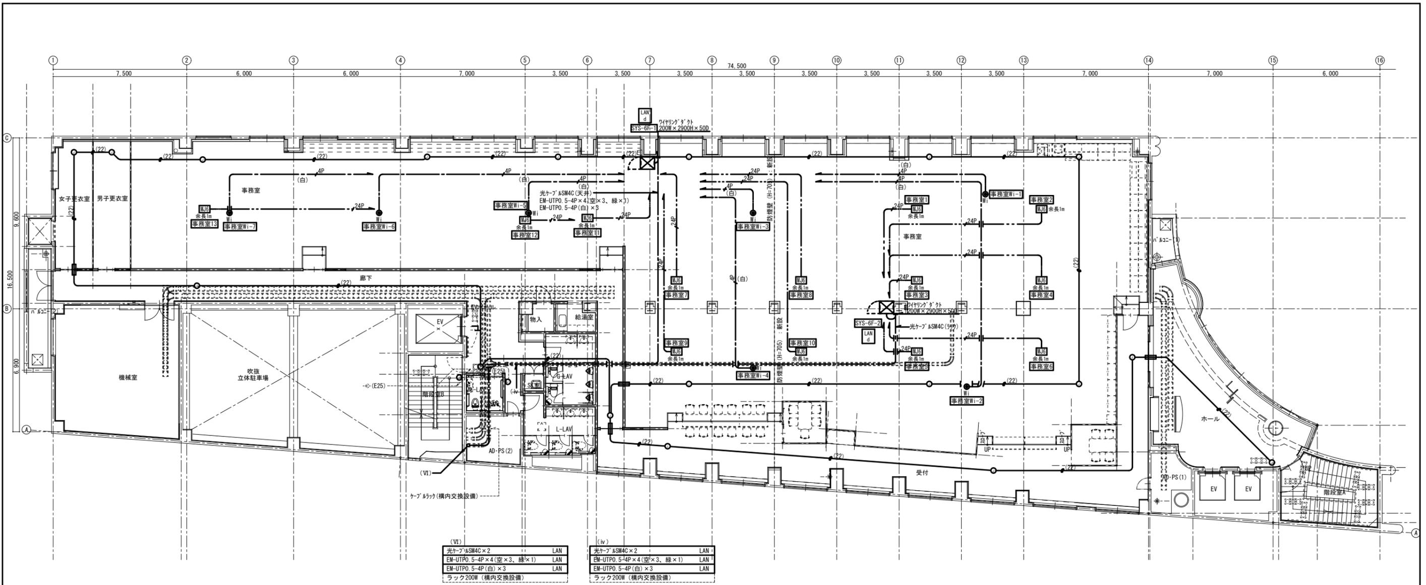
情報・防犯配管設備 6階平面図(改修) A1=1/100 ※細線が既設、太線が改修
