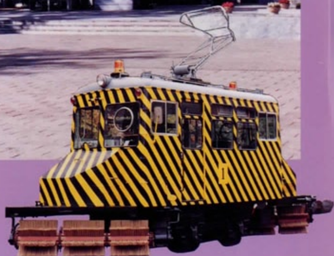
ブルーム式電動除雪車 (昭和24年11月製造・通称「ササラ電車」)
