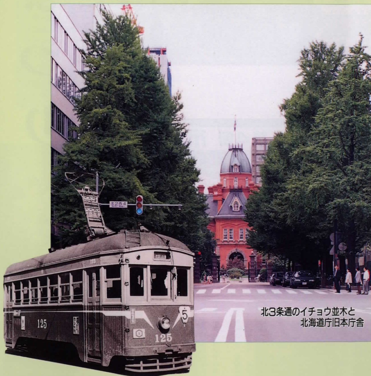
木製2軸電動客車 (昭和4年12月～昭和34年10月)
