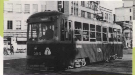
鋼製2軸ボギー電動客車 S315(製造)~S46.12(廃車)
