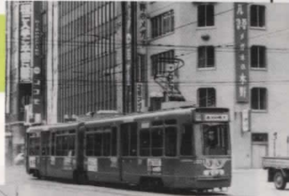
鋼製2連連接電動客車 S40.10(製造)
