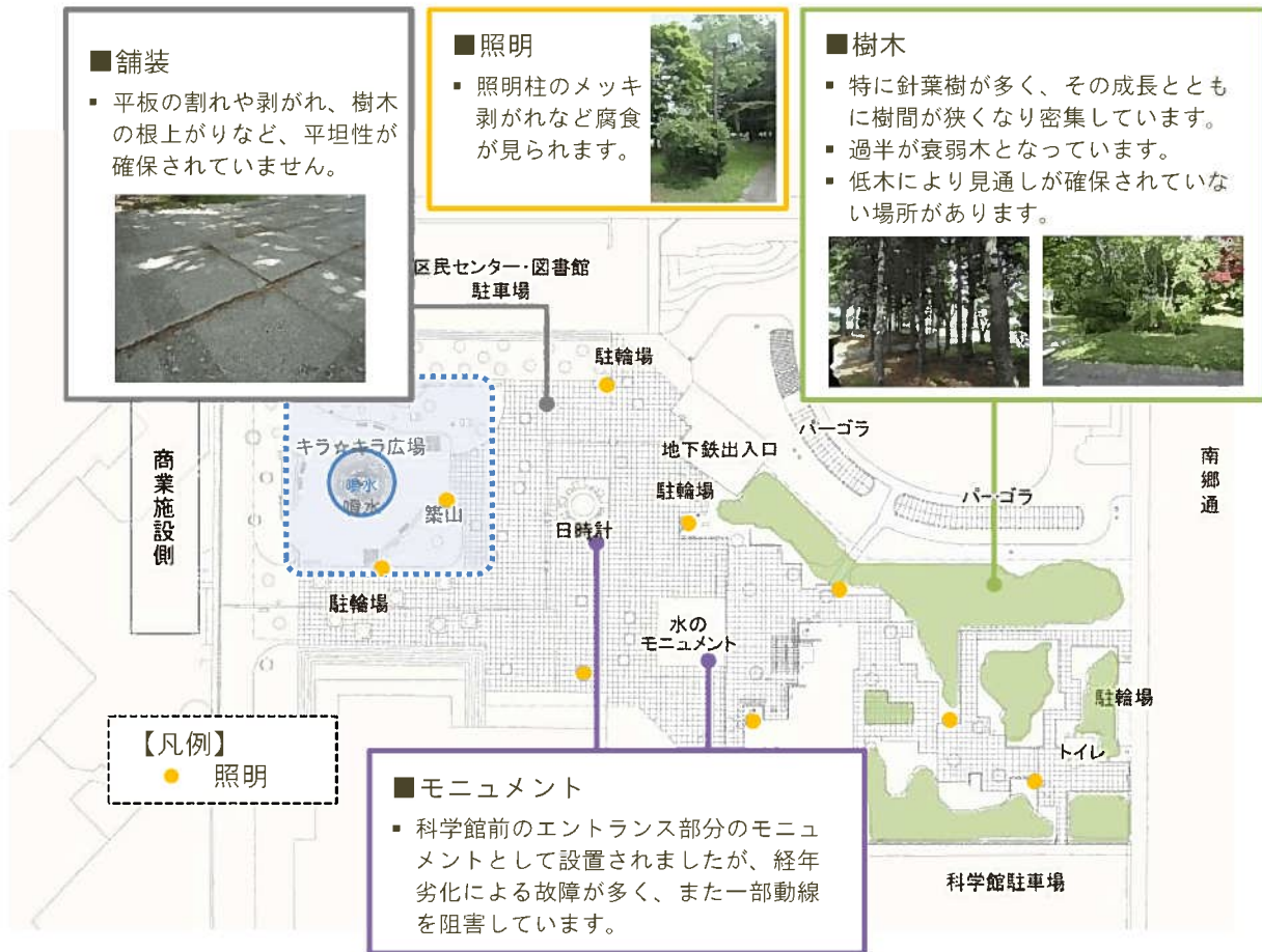
図 2-17 公園の老朽化の状況
