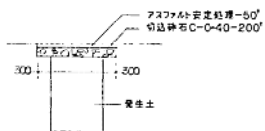
舗装復旧図 NO-SCALE (図面寸法詳分)
