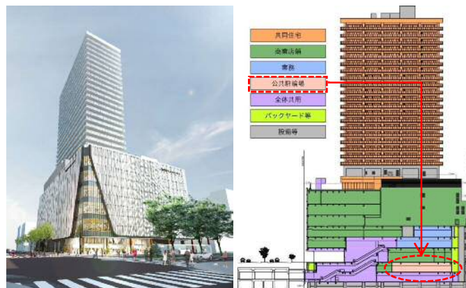
図 4-13 南2西3南西地区第一種市街地再開発事業における公共駐輪場整備のイメージ
