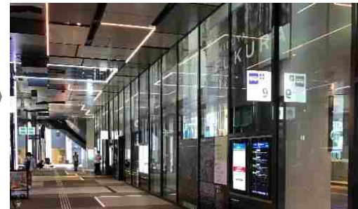
ホームドアにより車路と乗降場を空間的に分けて快適な待合環境を確保
