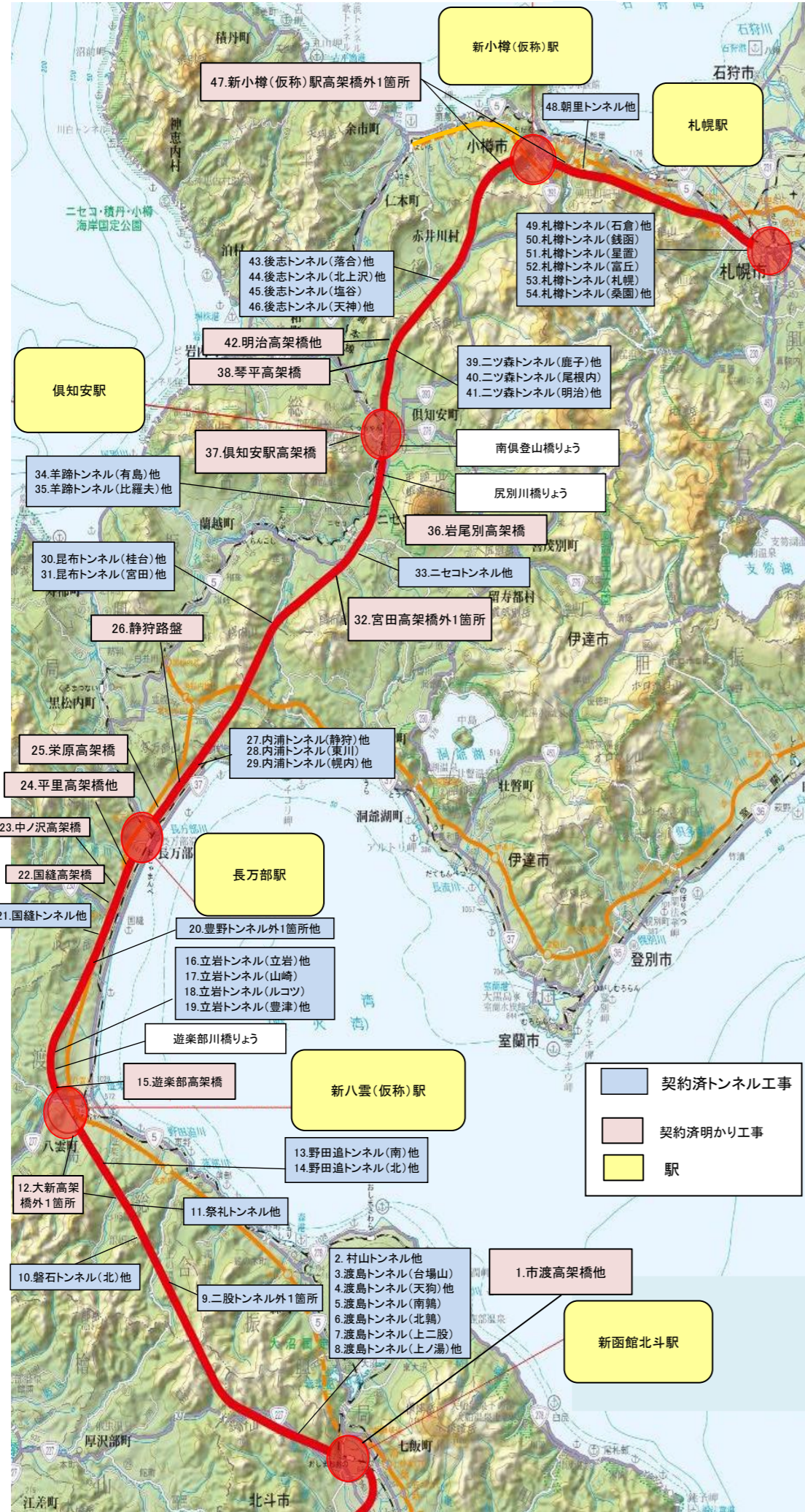
トンネル工事進捗状況
