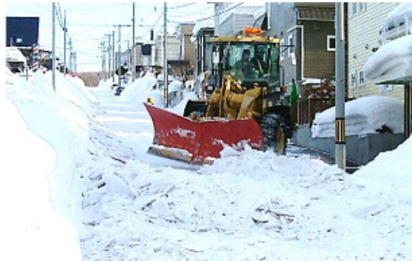
【図 6-21 枝から幹の路線に雪を押し出す作業（イメージ）】
