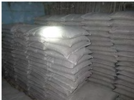
ピット内を調湿槽として有効活用を行ない、稚内産珪質頁岩26.5t 下川町産木炭2.7tにより調湿+臭い吸着を行なっている。
