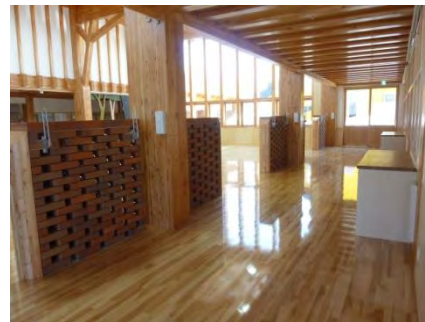
ギャラリーには放射レンガヒーターを設置、防寒着の物干しとしても利用
