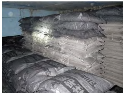
ピット内を調湿槽として有効活用を行ない、稚内産珪質頁岩26.5t 下川町産木炭2.7tにより調湿+臭い吸着を行なっている。
