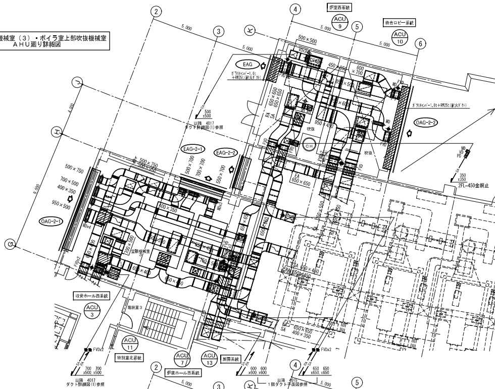
2階 空調機械室(3)・ボイラ室上部吹抜機械室 機械室内給排気ファン通り詳細図
