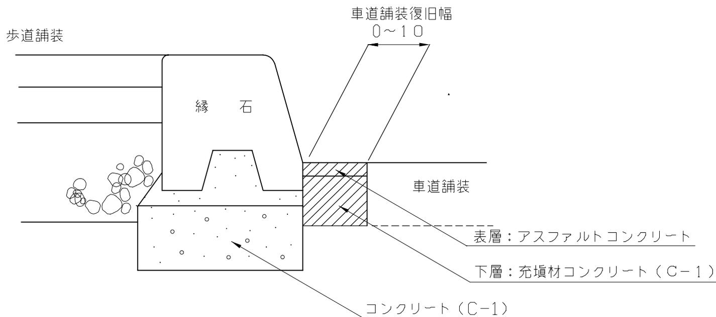
注記：取り壊し幅が10cmを超える場合は、アスファルト合材の使用を標準とする。(所定密度を確保すること)
