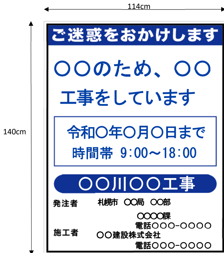
様式4（工事中看板（道路以外での工事））
