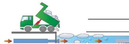
東部水再生プラザ融雪槽 (R7年度稼働開始予定)
