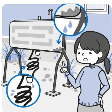
燃料タンクや配管の劣化、落雪による損傷などから、灯油漏れが多発しています。水道水や排水口から臭いがあるなどの影響が出る恐れもありますので、設備を自主点検し、事故を防ぎましょう。
