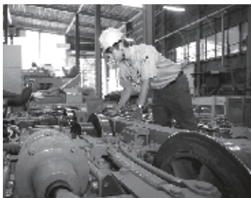
▲車両を解体して、部品一つ一つを丁寧に検査することもある
