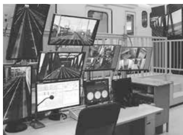
▲運転士・車掌が使用する、総合訓練室内の運転シミュレータ
