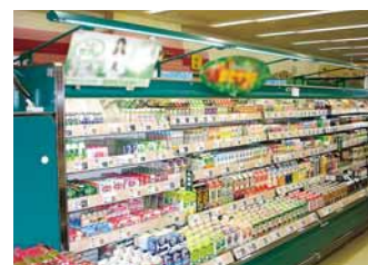
陳列棚ごとの照明を外し、上から照らすだけの方法に変えることで20%近い節電に成功。
