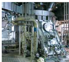
灰溶融炉。工場が発電した電気で動くため、停止すると余剰電力を北海道電力に売却できる。
