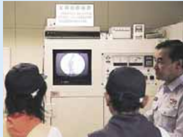
▲火災の原因解明のため、燃え残ったものを調査するエックス線透過装置。
