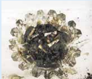
▲火災の原因となったタバコの火の不始末。割れた灰皿から火災のすさまじさがうかがえる。
