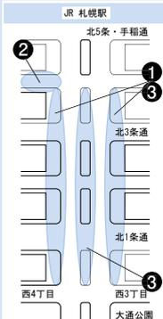
**工事内容**①地下埋設物移設②地下鉄さっぽろ駅改修③樹木移植④地下通路本体。
