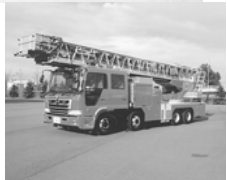
最大地上高50mの最新鋭のはしご車。15階の高さでも救助活動が可能で、高層建築物での火災時に活躍する
