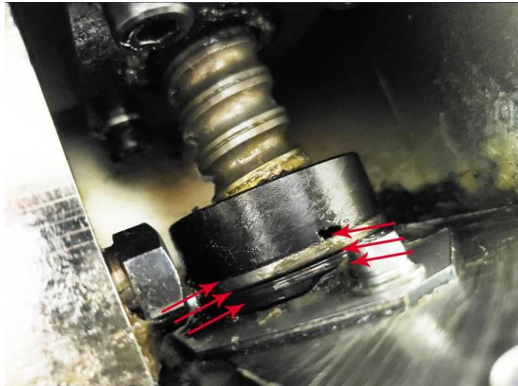
※1つのスラストベアリングに対して必ず二方向からスプレーする。
