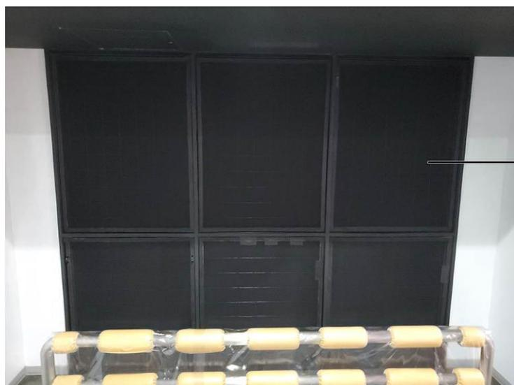
※吸気口フィルターがごみや埃等により目詰まりした状態での稼働は、装置に余分な負荷を与え、装置が故障したり、寿命が短くなる。
