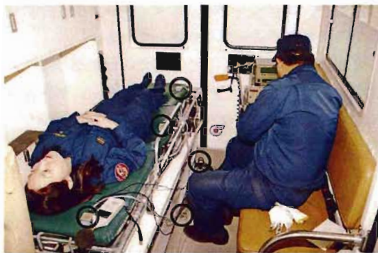
写真4 測定位置及び加速度変換器
