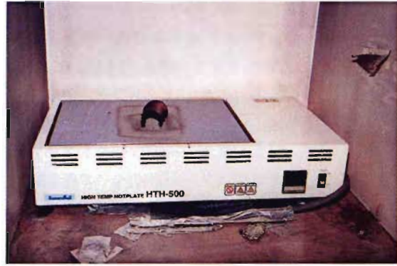
写真7 ホットプレート上の燻焼後の木材の状態
