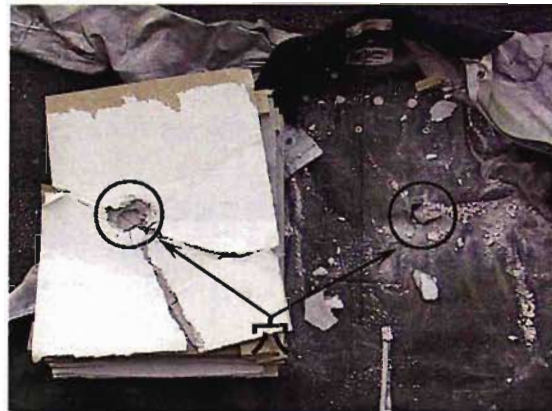
写真5 缶が衝突した防火衣
