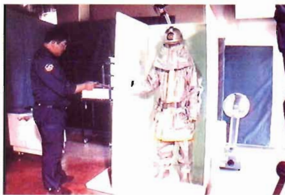
写真5 防火衣着用で水を掛けている状況
