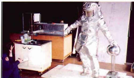
写真4 耐熱服着用で静電気帯電測定状況
