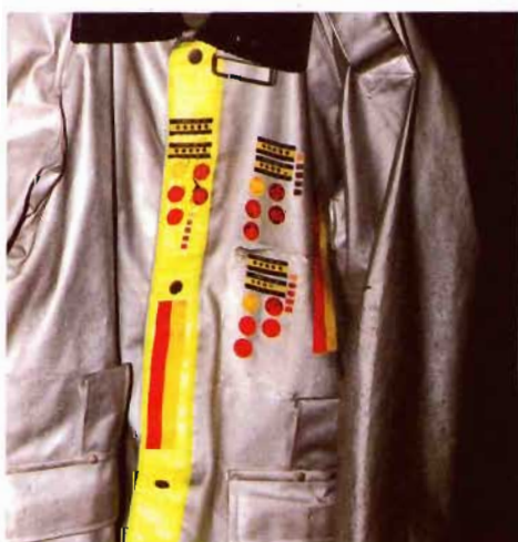
写真7 実験5のサーモラベルの温度表示状況
