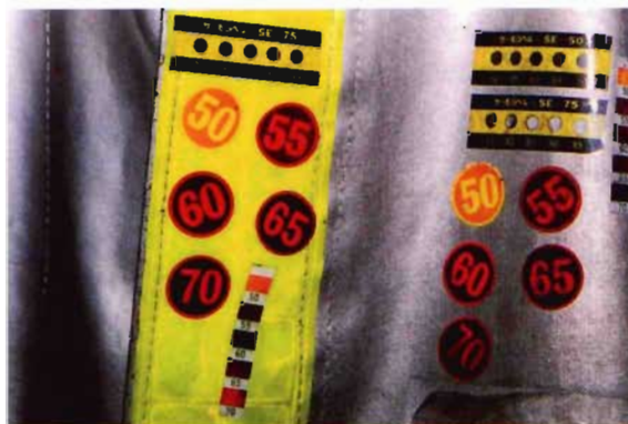
写真5 実験1のサーモラベルの温度表示状況2
