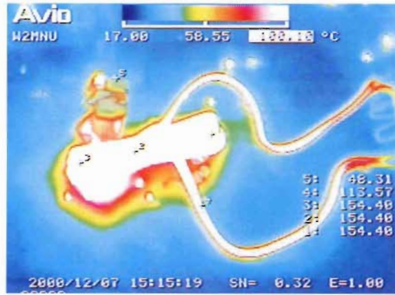
写真28 熱画像装置・実験5開始 102秒経過短絡
