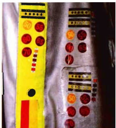
写真4 実験1のサーモラベルの温度表示状況1
