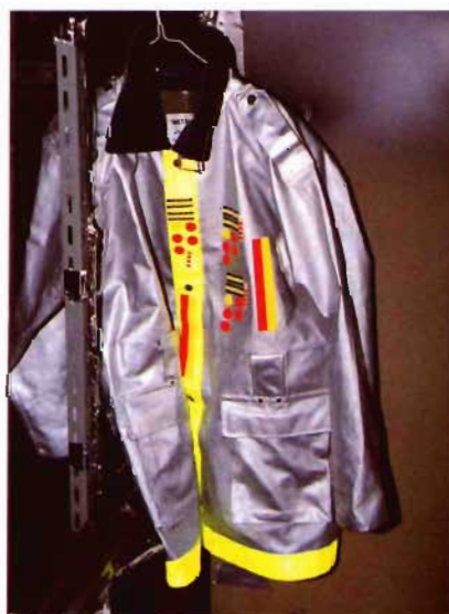
写真3 各種サーモラベルの貼付状況
