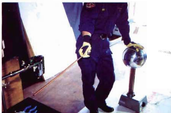
写真3 現場用手袋での静電気容量測定実験
