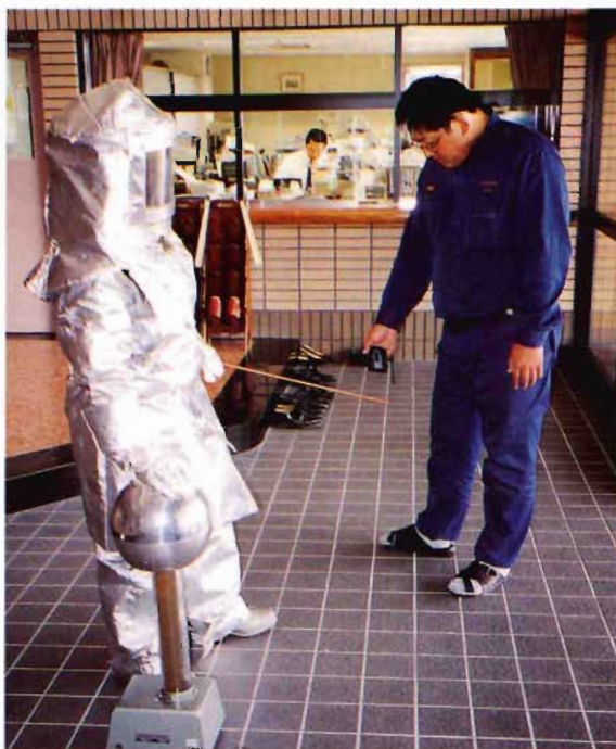
写真6 消防学校での耐熱服着用による自然放電状況測定
