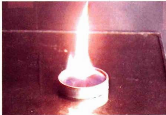
写真3 アセトンの着火状況
