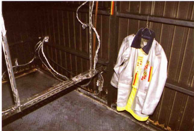
写真2 燃焼実験ハウス内に防火衣上衣を掛けた状況
