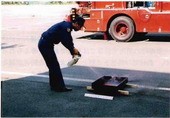
写真7 イソプロピルアルコールを燃焼させた場合の水による消火実験
