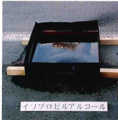
写真9 イソプロピルアルコールの消火後 ※ 燃焼面には少量の消火薬剤が残り、イソプロピルアルコールが全て燃焼していないため、再度点火することが容易である。
