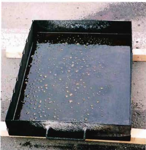
写真8 現行の模擬火点用燃料の消火後 ※ 燃焼面が消火薬剤で覆われ、粘着状になっているために、再度点火することが困難である。
