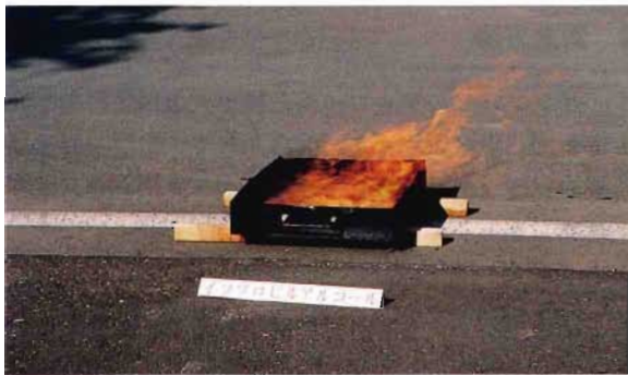
写真2 イソプロピルアルコールの発煙状況
