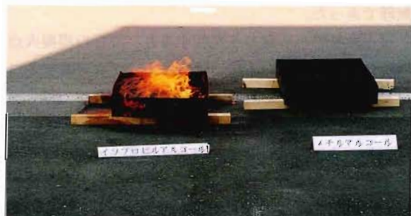
写真10 イソプロピルアルコールとメチルアルコールの燃焼状態の比較
