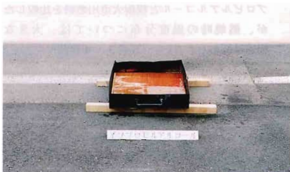
写真5 燃焼板にイソプロピルアルコールを浸した場合の燃焼状況
