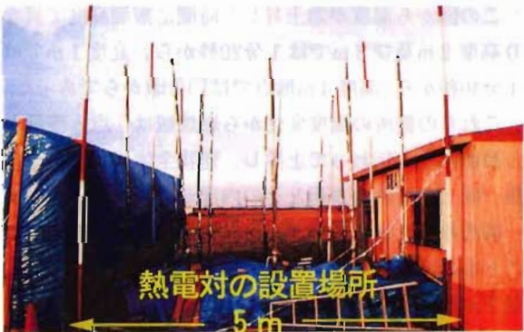
写真1 (①～③) 熱電対の設置状況
