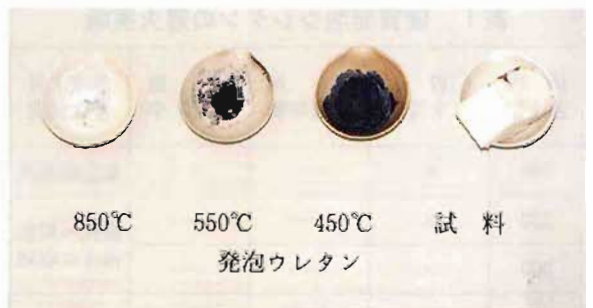
写真35 煙濃度の測定
