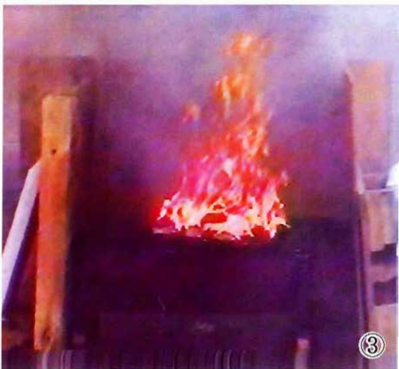
写真38 燃焼時の注水による影響
