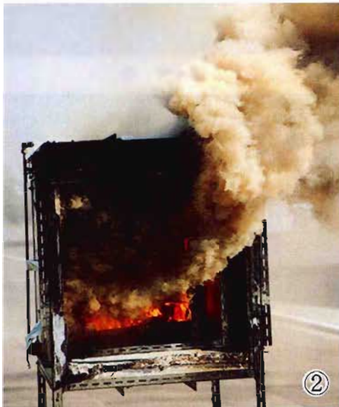
写真42 (①~③) 区画模型 (0.716 m 3 ) による燃焼実験(4)
