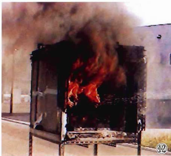
写真42 (10~15) 区画模型 (0.716 m 3 ) による燃焼実験(4)
