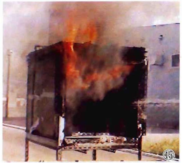
写真42 (10~15) 区画模型 (0.716 m 3 ) による燃焼実験(4)
