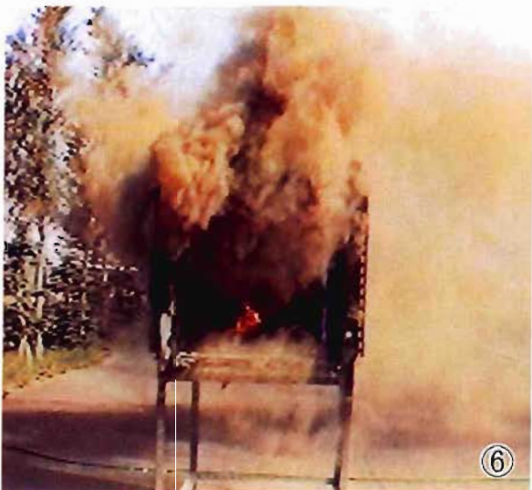
写真42 (④～⑨) 区画模型 (0.716 \text{m}^3 ) による燃焼実験(4)
