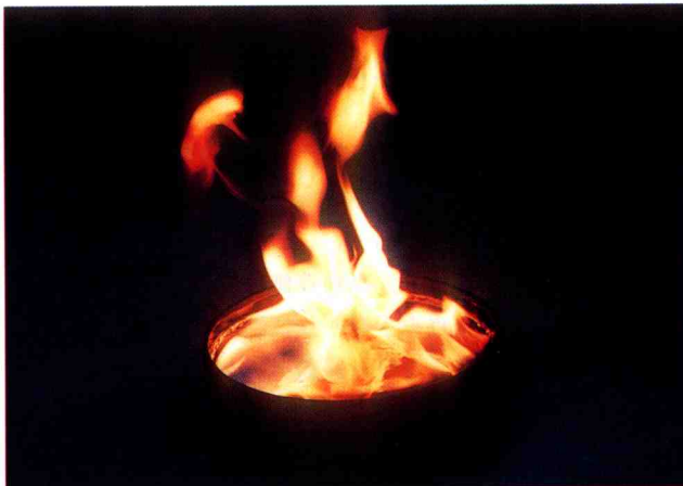
写真2 燃焼灯油の作成状況 (20cmシャーレ)
