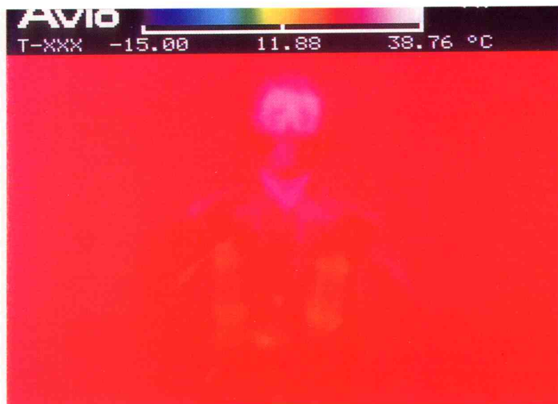
写真7 作業服表面の熱画像（防火衣A）
