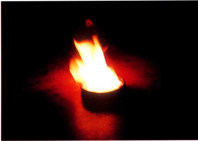
写真1 燃焼灯油の作成状況 (10cmシャーレ)
