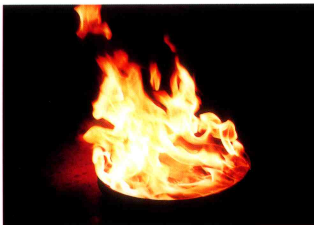
写真3 燃焼灯油の作成状況 (30cmシャーレ)
