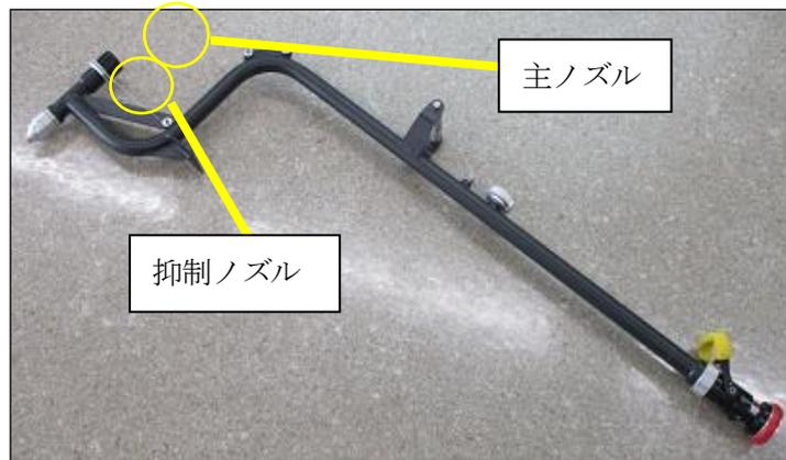
図1 水力換気ノズル
