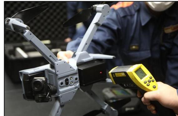
図 11 放射温度計による測定
