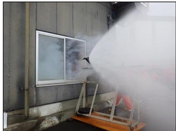
図 17 離隔距離 900 mm、噴霧放水角度 90°
