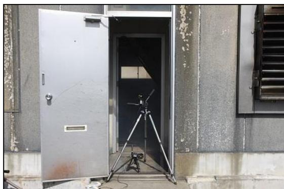
図 9 風速計の設定状況
