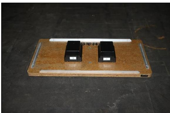
図6 低温実験ユニット内のバッテリー
