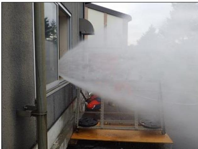
図 13 検証 1 基準噴霧放水角度(約  $70^\circ$ )
