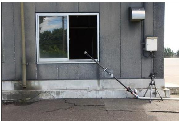
図 7 水力換気ノズルの設定状況
