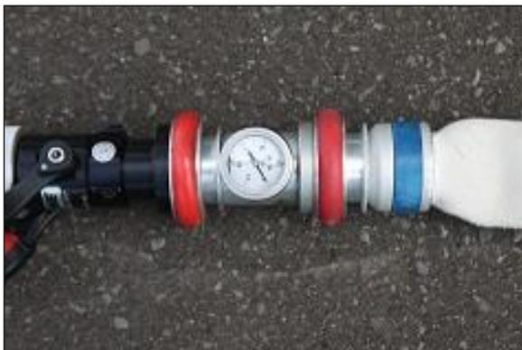
図 9 水力換気ノズルに接続した圧力計
