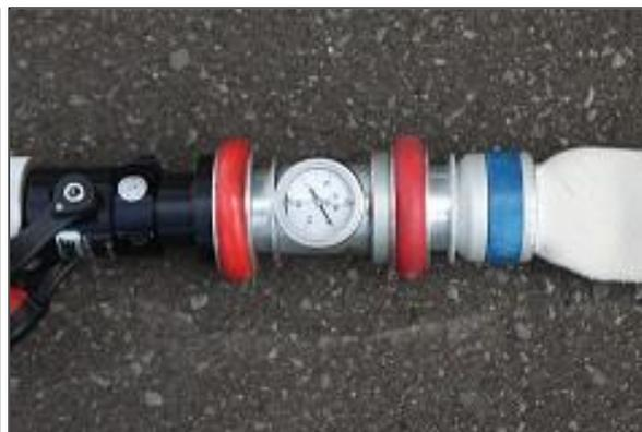
図 8 水力換気ノズルに接続した圧力計
