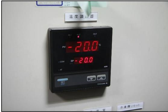
図 8 低温実験ユニット内の設定温度
