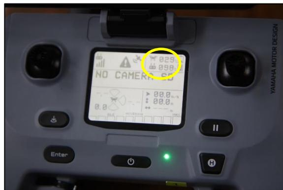
図5 送信機によるバッテリー残量の確認
